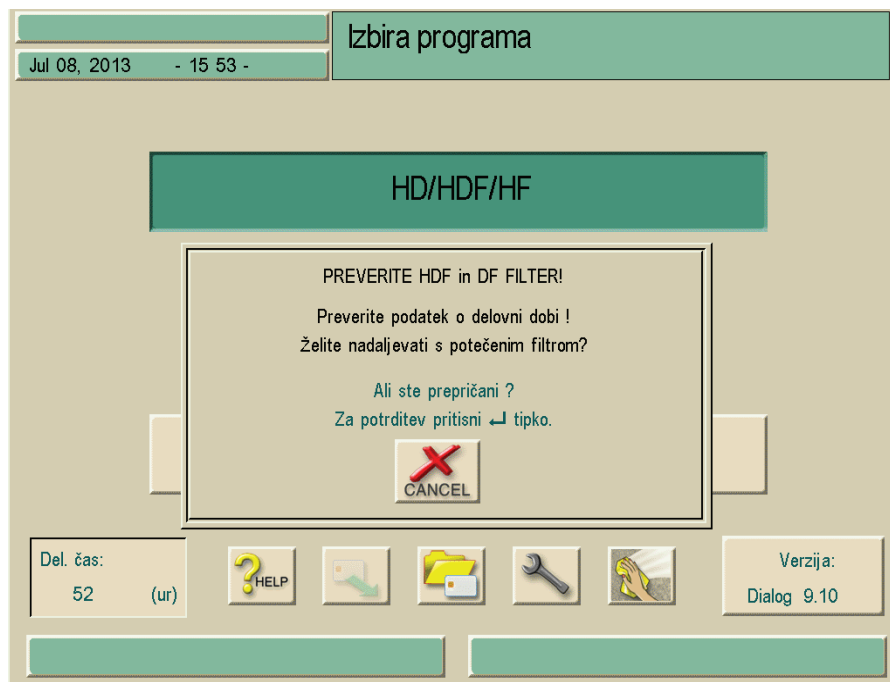
Sl. 9-11 Informacijsko okno "Zamenjava filtra"
