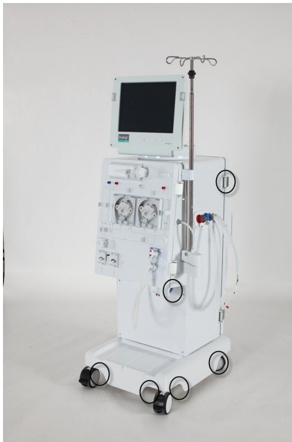
Sl. 4-3 Držalne točke za prenašanje dializnega aparata
