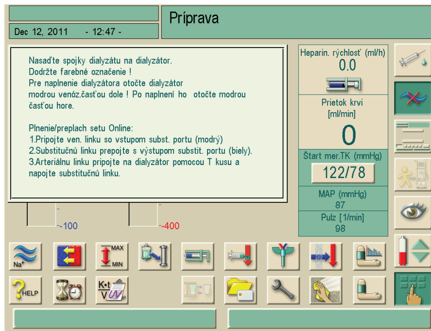
Zobr. 9-4 Informačné okno na pripojenie dialyzátora
