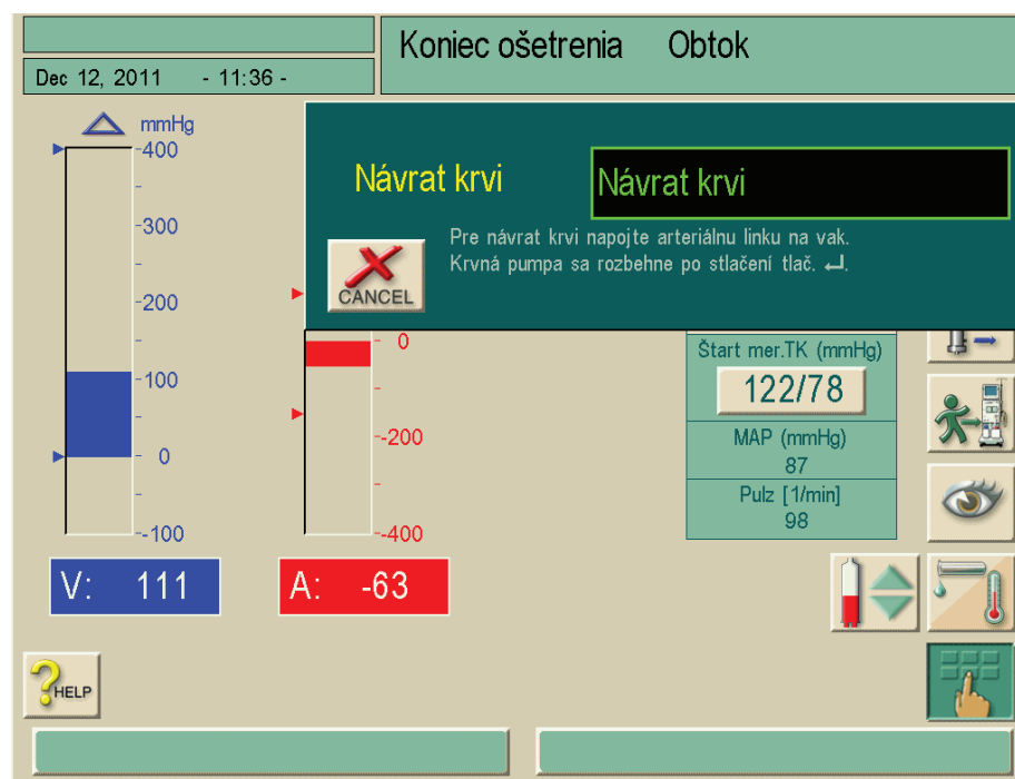
Zobr. 7-1 Obrazovka „Potvrdenie návratu krvi“
