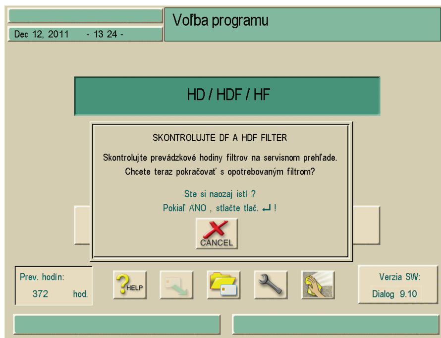
Zobr. 11-28 Výstražné okno „Výmena filtra“
