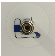
Zobr. 11-3 Konektor s vnútorným závitom na dialyzačnom prístroji
