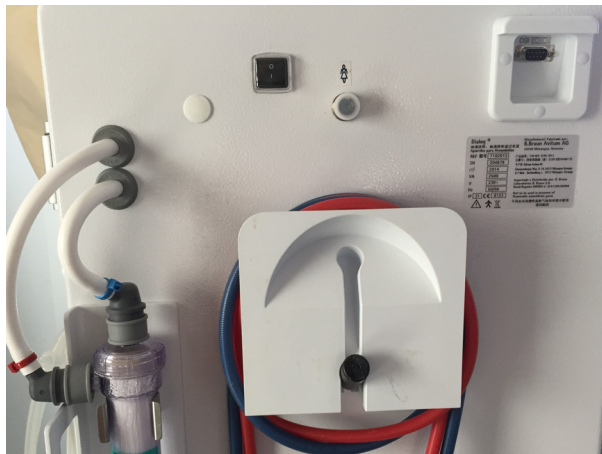
Imaginea 4-1 Depozitarea cablurilor și a tuburilor
