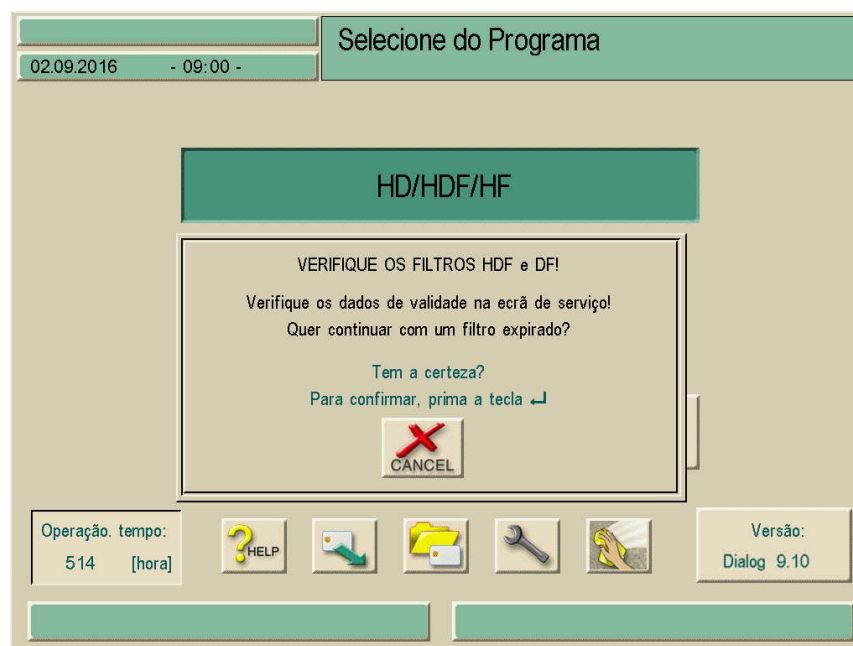
Fig. 10-24 Janela com o aviso “Troque o filtro”
