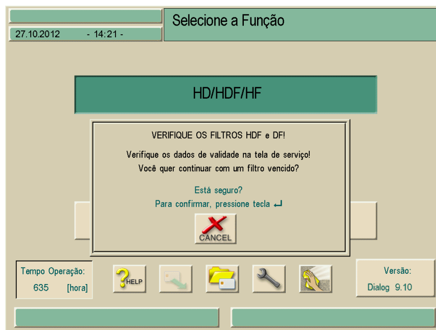
Fig. 10-24 Janela com o aviso “Troque o filtro”
