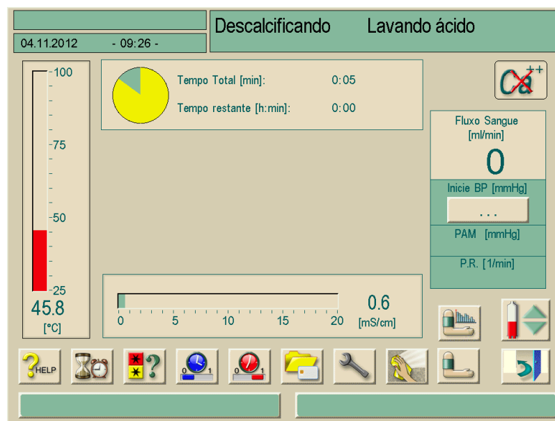
Fig. 7-13 Tela de “Descalcificação” – Lavagem do Ácido
