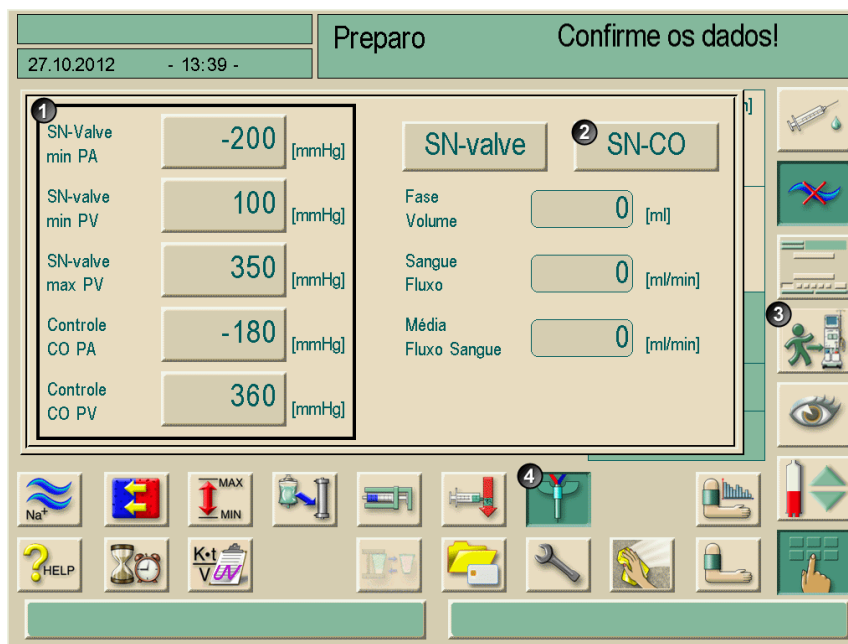
Fig. 9-2 Punção única cross-over (SN-CO)
