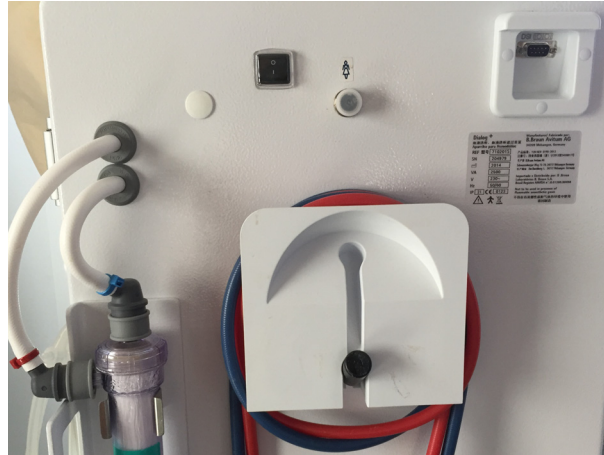
Abb. 4-1 Lagerung von Kabeln und Schläuchen
