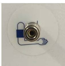
Att. 11-3 Sievišķais savienojums uz dialīzes aparāta
