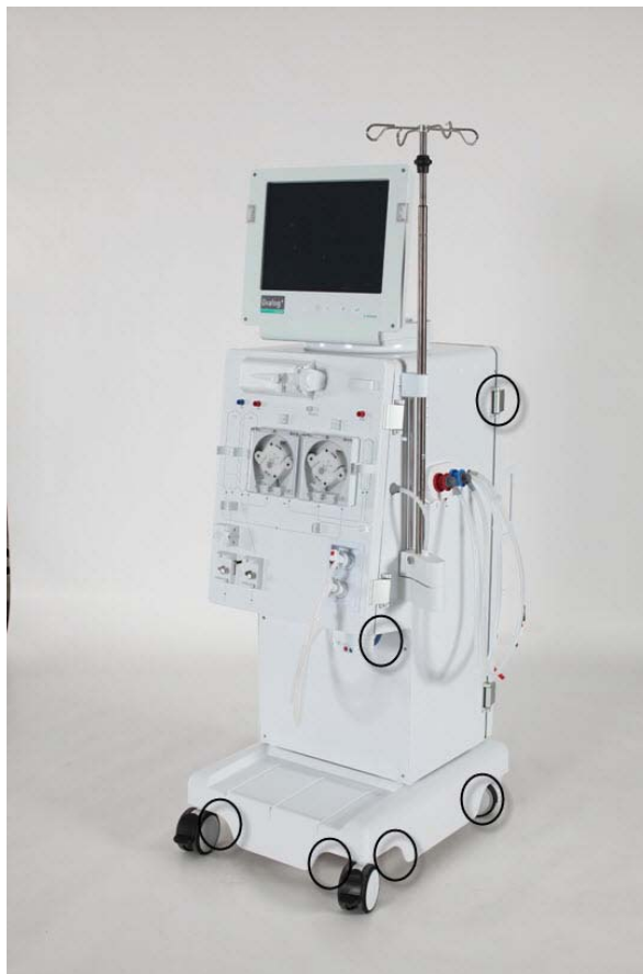
Att. 4-3 Turēšanas punkti, nesot dialīzes aparātu
