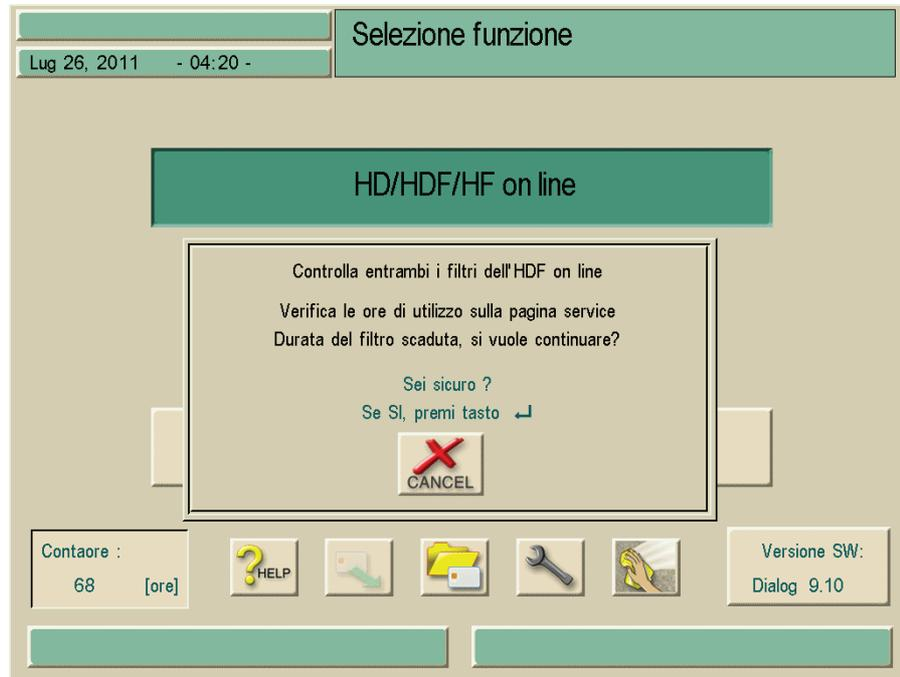
Fig. 9-11 Finestra informativa "Sostituzione filtro"
