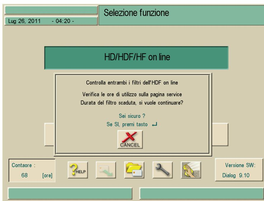
Fig. 11-28 Finestra di avvertenza "Sostituzione filtro"
