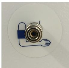
Fig. 11-3 Connettore femmina sull'apparecchiatura
