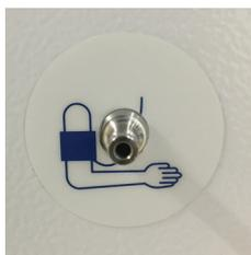
Fig. 11-1 Connettore maschio sull'apparecchiatura
