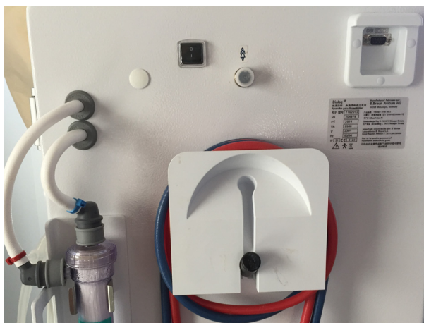
Fig. 4-1 Stockage des câbles et des tubes
