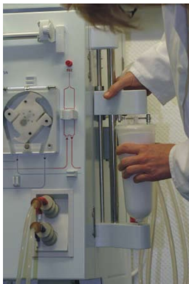
Fig. 11-22 Insertion d'une cartouche
