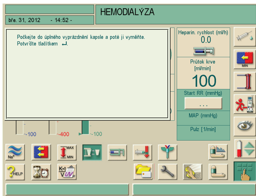
Obr. 11-24 Výměna bikarbonátové kapsle s vyprázdněním
