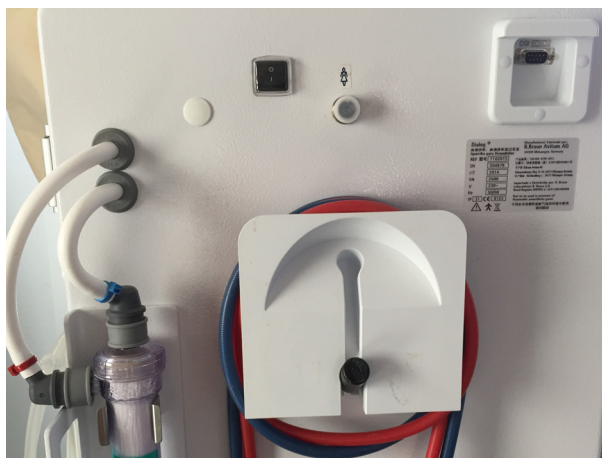
Obr. 4-1 Uložení kabelů a hadic
